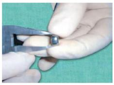
**Gambar 12.3** Pengukuran diameter SSC menggunakan Caliper (Marwah, 2018)
