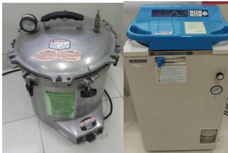
**Gambar 6. Autoklav manual dan otomatis**
